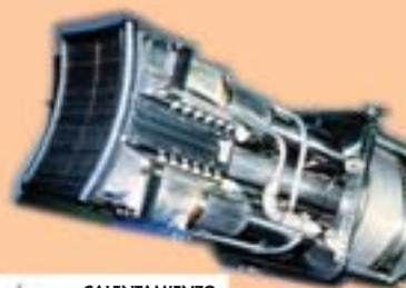
Antena de radio-frecuencia en «Tore Supra» (CEA, Cadarache, Francia)
