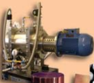
Bomba de extracción de tritio
